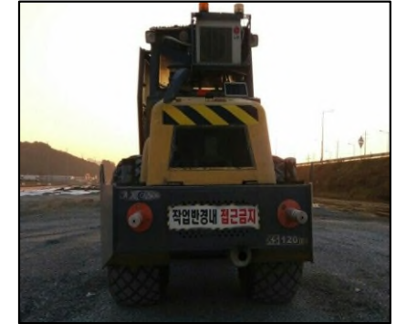
< 후방 경고기 설치 >
