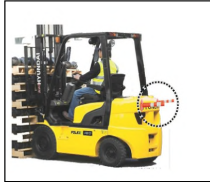
< 협착 방지봉 설치 >
