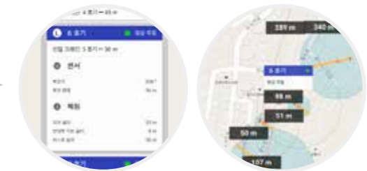
▲ 크레인 클릭 시 상세 정보 표시 및 근접 크레인의 거리 실시간 모니터링 가능
