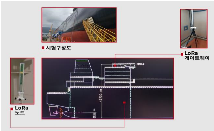
공사 밀폐구역 / 선박 내부 통신 테스트 (모든 구역 통신성공, 최대 2km)
